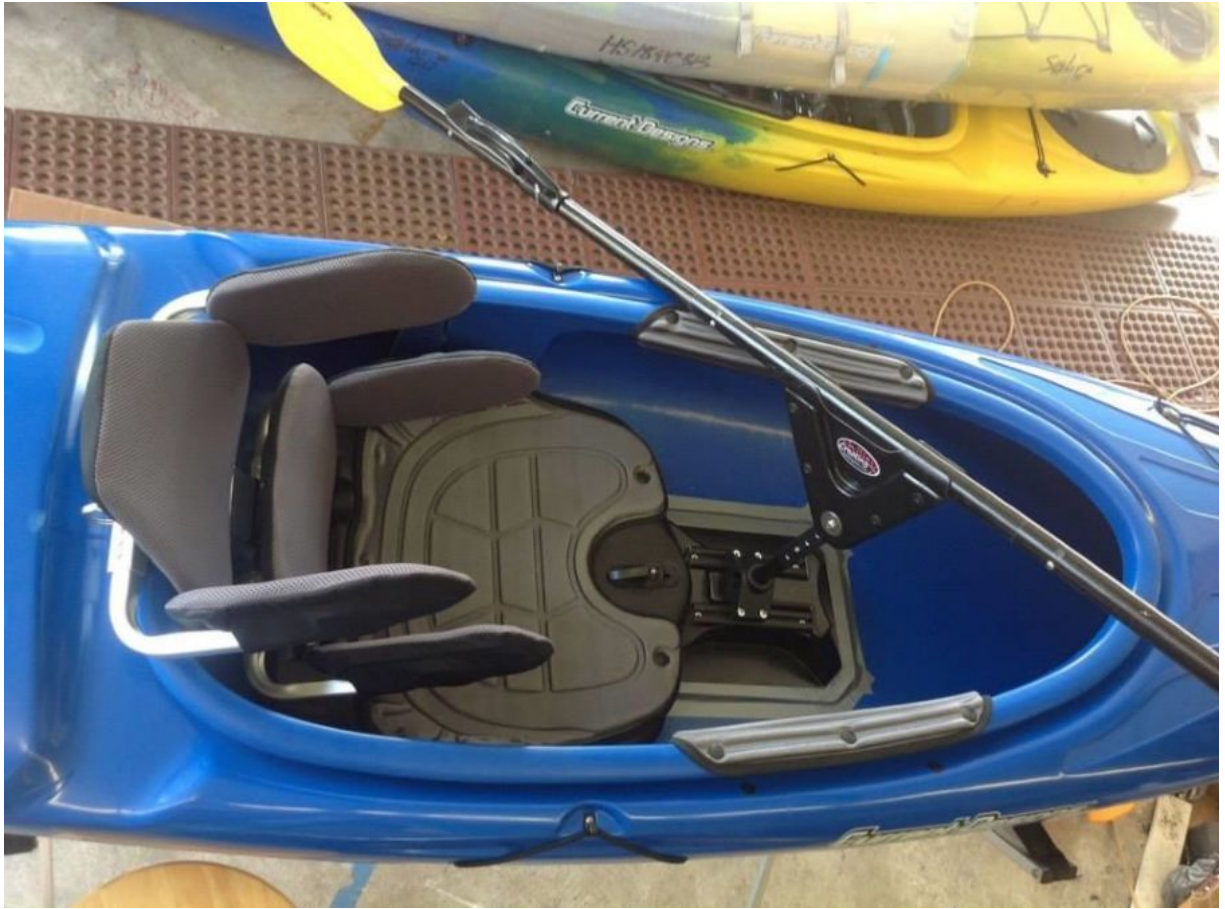
Årefører/ åreholder - holder åren fast til kajakken, gir åren retning og lar åren gå i bane.
